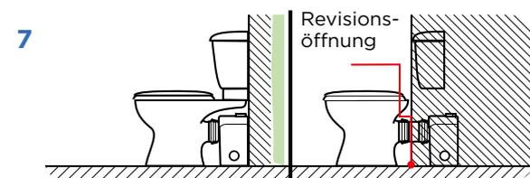
7 Das Gerät muss hinter der Toilette installiert werden und leicht zugänglich sein. Bei einer Installation in einer Vorbauwand ist eine Revisionsöffnung (mind. 50x50 cm) vorzusehen.
