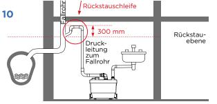
Beim Einsatz unterhalb der Rückstauebene ist zur Absicherung eine Rückstauschleife in die Druckleitung einzubauen.
